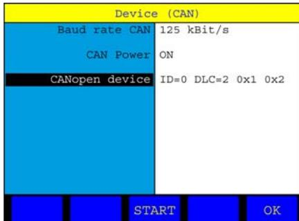
Stellen Sie die Baudrate auf den im Patrick-Bedienmenü eingestellten Wert (hier: „125 kBit/s“) ein und aktivieren Sie die Stromversorgung des CAN Bus (CAN Power „EIN“).
